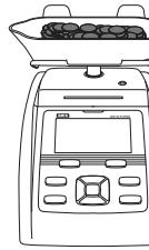
4.硬貨を載せたスクープを下ろし、ホッドが空になると「ジドウカサン」の表示があり、計数が完了します。
