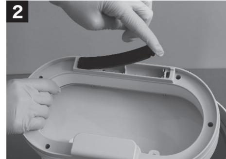
●開閉ユニット裏面に付いているバッテリーカバーを開けます。
