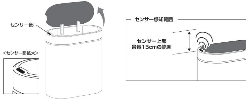
①センサー部(上図)のセンサー上に手をかざすと、センサーが感知し、ふたが自動的に開きます。
